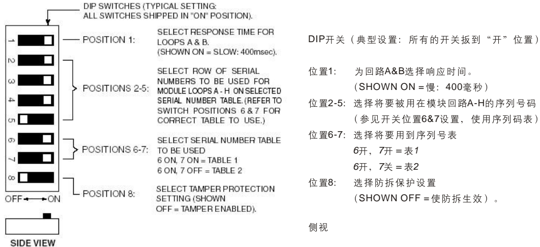
图3: DIP开关设置
